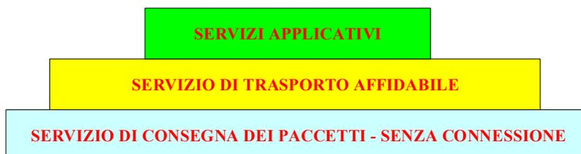
Figura 4.1 – Struttura a livelli dei servizi in TCP/IP.
