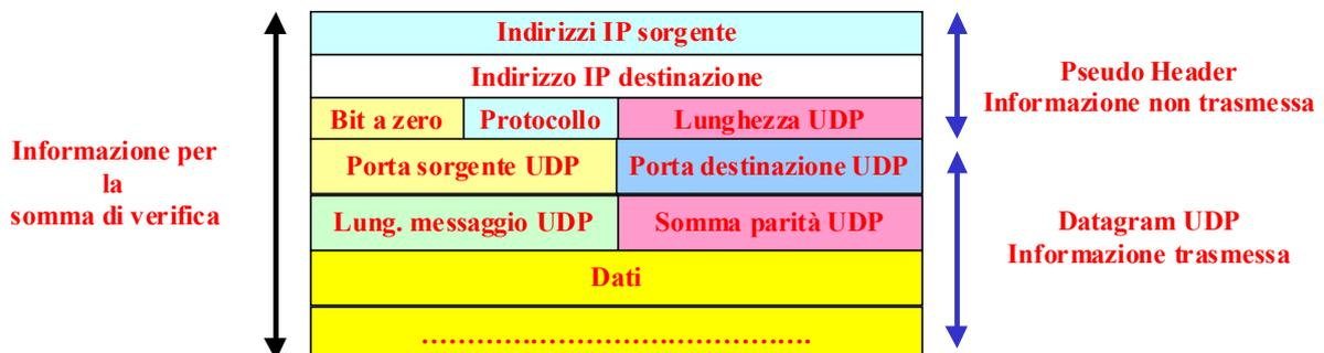
Figura 4.23 – Formato del datagramma utilizzato per il calcolo del checksum nel protocollo UDP.
