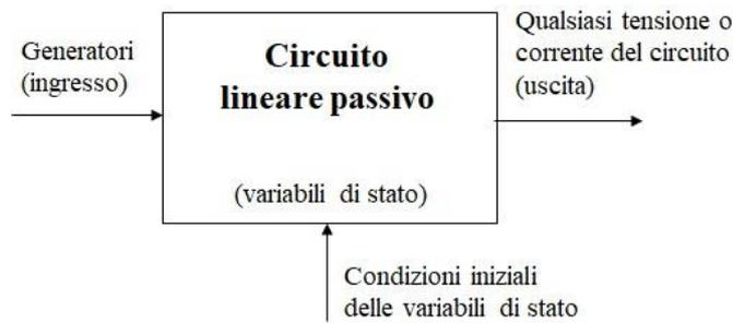
Fig. 6.3 – Sistema ingresso – stato - uscita.
