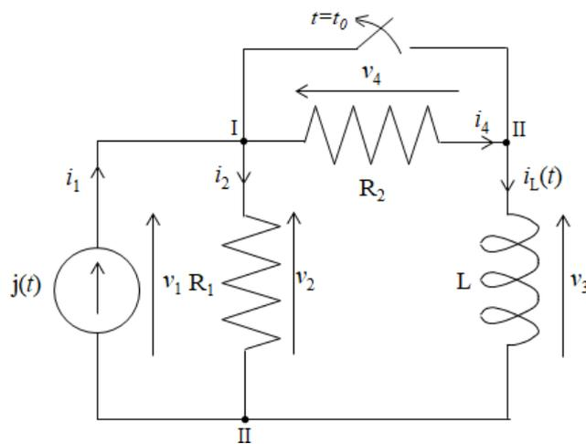
Fig. 6.17 – Circuito dinamico del I ordine con interruttore.
