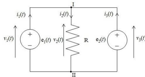
Fig. 6.1 – Esempio di circuito con una patologia.
