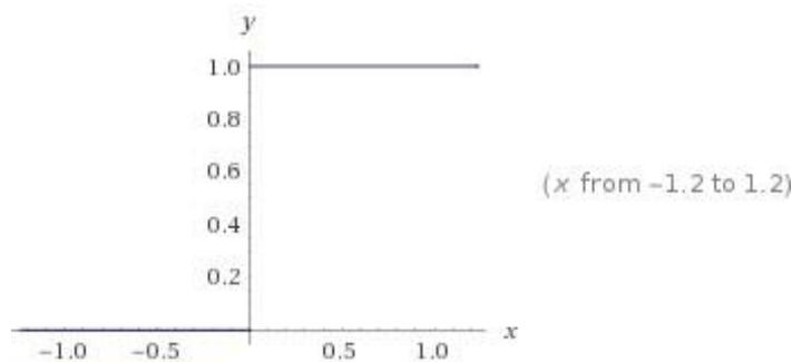
Fig. 6.20 – grafico della funzione gradino unitario  $u(t)$  della (6.85)
