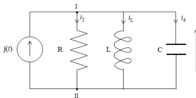
Fig. 6.24 – Circuito RLC parallelo.
