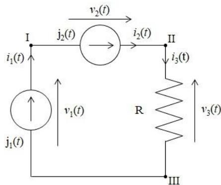
Fig. 6.2 – Esempio di circuito con una patologia.
