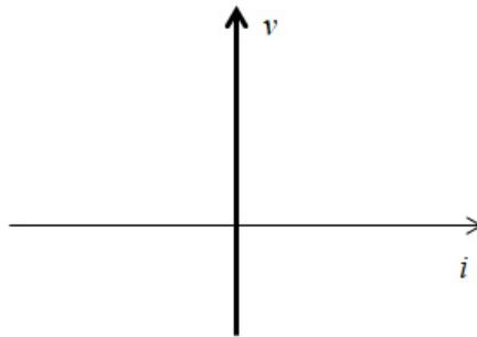
Fig. 2.6 – Curva caratteristica di un circuito aperto.
