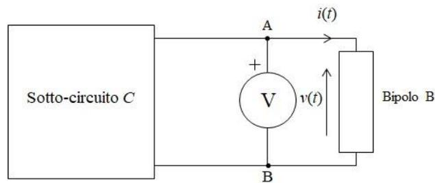
Fig. 2.26 – Inserimento di un voltmetro V.
