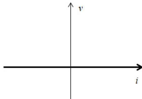
Fig. 2.4 – Curva caratteristica di un corto circuito.
