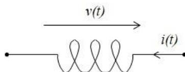
Fig. 2.19 – Simbolo del bipolo induttore.
