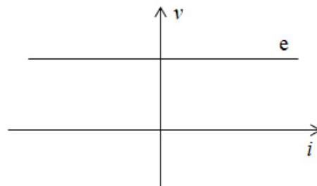
Fig. 2.8 – Curva caratteristica di un generatore ideale indipendente di tensione.
