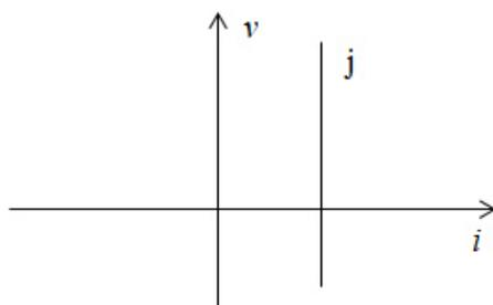
Fig. 2.11 – Curva caratteristica di un generatore ideale indipendente di corrente.
