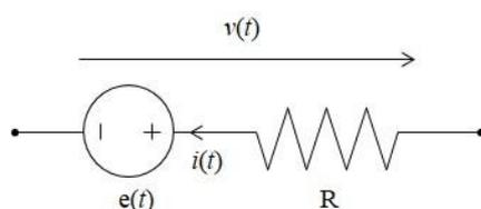
Fig. 2.12 – Rappresentazione di un generatore reale indipendente di tensione.
