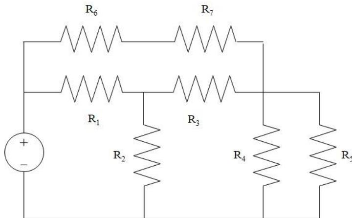
Fig. 2.24 – Circuito resistivo con serie e parallelo di resistenze.
