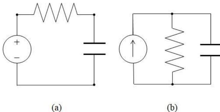
Fig. 2.18 – Circuiti di carica di un condensatore, serie (a) e parallelo (b).
