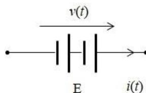
Fig. 2.9 – Simbolo del generatore ideale di tensione costante.
