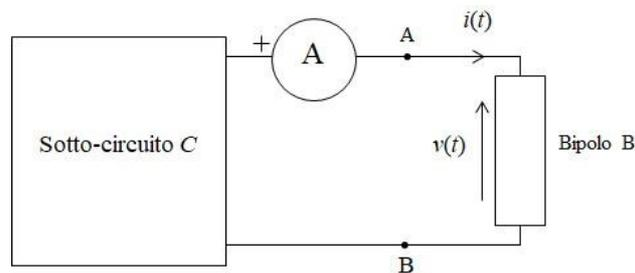
Fig. 2.27 – Inserimento di un Amperometro A.
