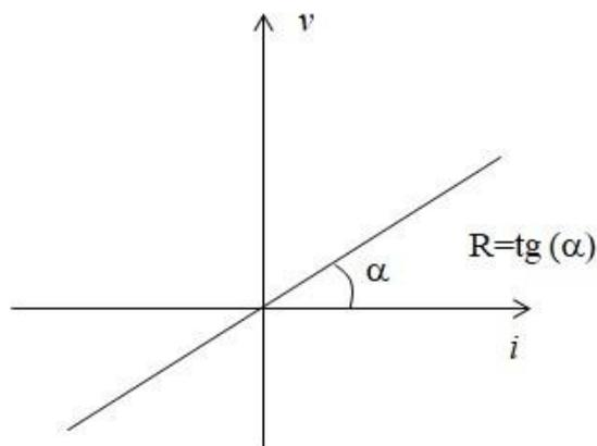
Fig. 2.2 – Curva caratteristica di un resistore lineare.
