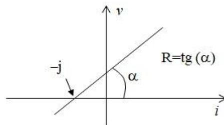
Fig. 2.15 – Curva caratteristica di un generatore reale indipendente di corrente.
