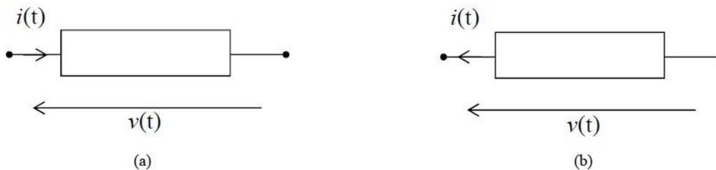
Fig. 1.8 – a: Convenzione dell'utilizzatore, b: Convenzione del generatore.
