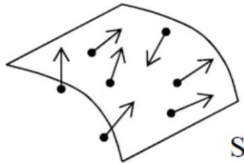
Fig. 1.3 – Superficie attraversata da cariche elettriche in movimento.
