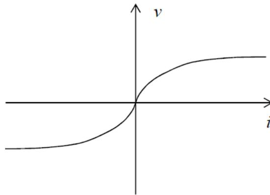
Fig. 1.10 – Grafico di una funzione caratteristica di un resistore non lineare.
